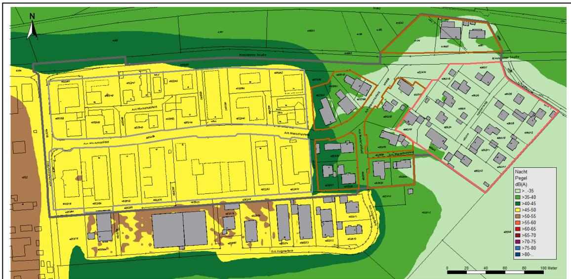
**Abbildung 9:** Beurteilungspegelkarte nach TA Lärm, Nachtzeitraum (22-6 Uhr), Berechnungshöhe  $h = 6$  m üGOK
