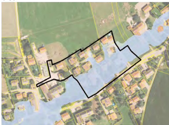
Abbildung 4: Hochwassergefahrenflächen HQ100 dunkelblau und HQextrem (hellblau)
